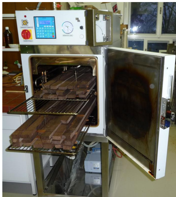
Komora za termično modifikacijo lesa, ki je izdelana po našem patentu št.: SI 22506 A
